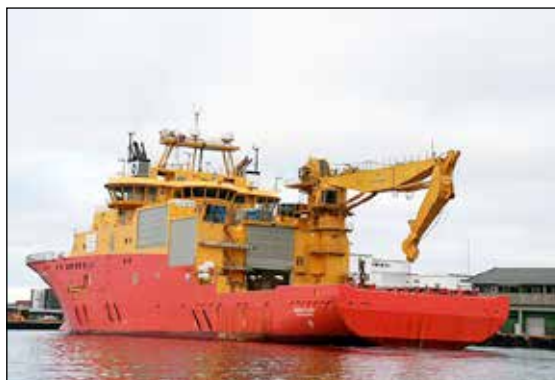
Fem st B16 dimensionerade för extremt höga vindlaster. Monterade på Edda Fauna, supplyfartyg för norska oljeindustrin.
